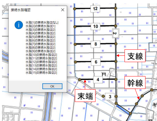
図2: 水路の接続状況を自動判定した結果の例 [6] Automatically recognized connection between channels
